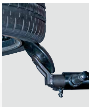
REVOLVER MULTIFUNZIONE 4 UTENSILI - 3 POSIZIONI - ROTAZIONE AUTOMATICA
