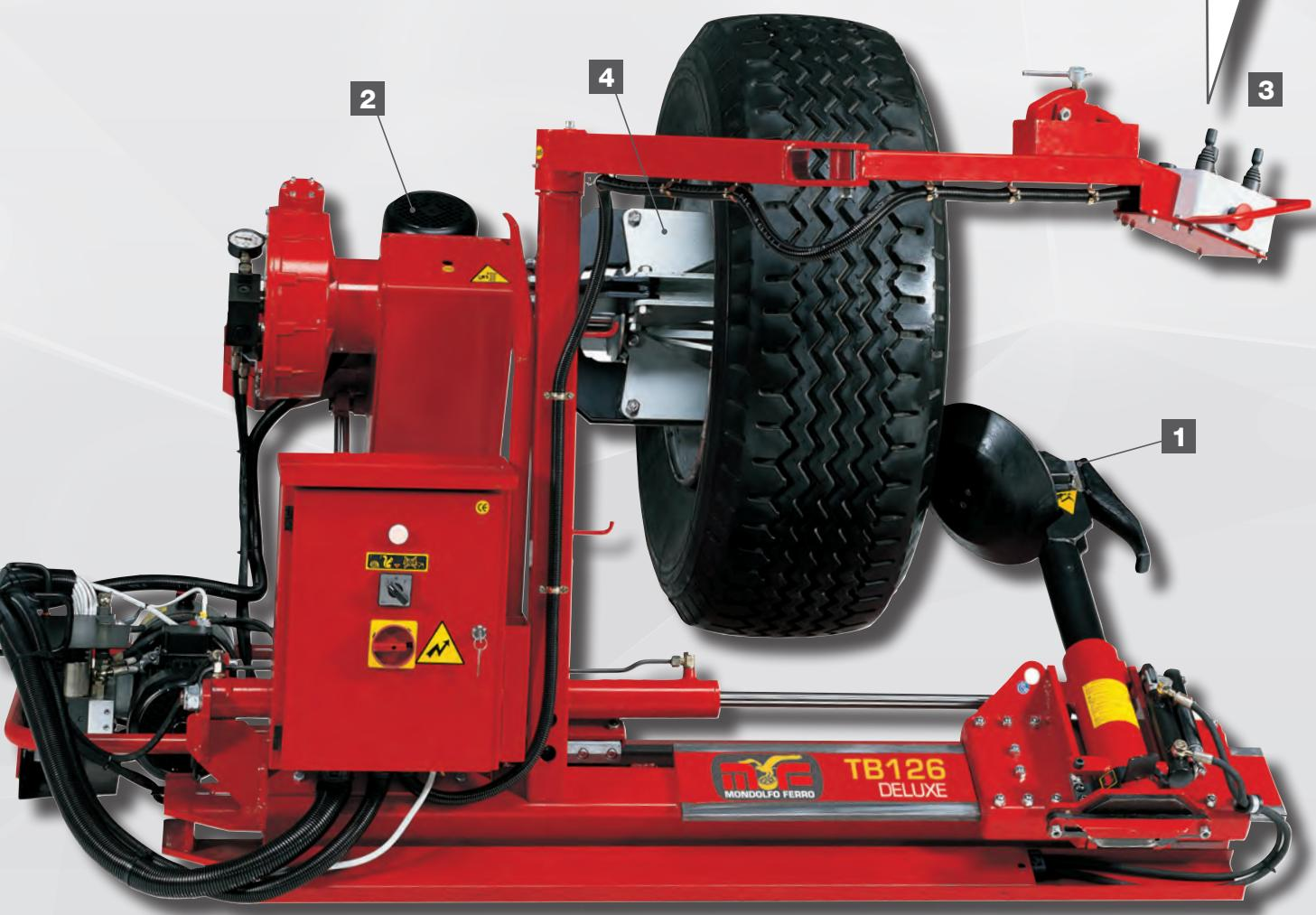
Macchina dotata di **TRASLAZIONE SIMULTANEA** (modelli Deluxe e Super) e di **solido braccio snodato** che permette di eseguire tutte le operazioni da qualsiasi posizione di lavoro senza intralci da parte dei comandi e che permette all'operatore di mantenere liberi i piedi durante le varie fasi di lavoro.
