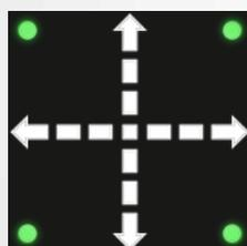
Die integrierten Übersichtsanzeige **mit Leuchtanzeige** ermöglicht dem Bediener das Überprüfen des Kopplungs-Status der Targets und führt ihn durch die verschiedenen Bedienschritte. Bei Kompensations- und Lenkvorgängen geben die aufleuchtenden Pfeile klare Informationen über den laufenden Vorgang.
