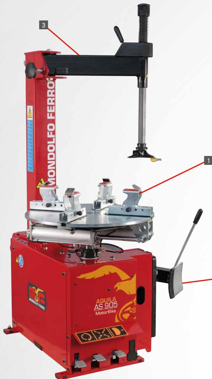
Grande attenzione è stata riservata al **sistema di bloccaggio ruota.** Sia le **griffe standard** che quelle **speciali** permettono un corretto bloccaggio e la **salvaguardia del profilo cerchio.**
