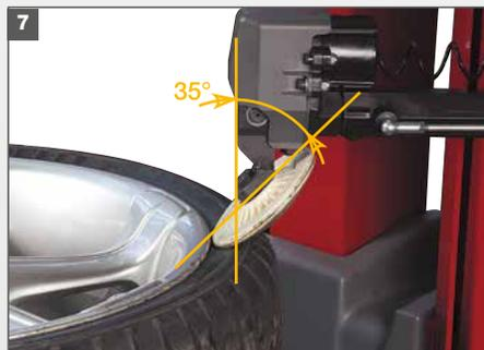
**8-9-10.** Dispositivo di smontaggio **SENZA LEVA**, applicata al sistema di estrazione, **elimina completamente lo sforzo fisico dell'operatore e garantisce massima sicurezza per cerchio e pneumatico.**
