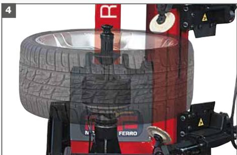
**4. Bloccaggio pneumatico integrato** che permette un facile posizionamento della ruota sull'autocentrante, senza alcuno sforzo e consente di stallonare i due talloni con un unico movimento, senza dover girare il cerchio.
