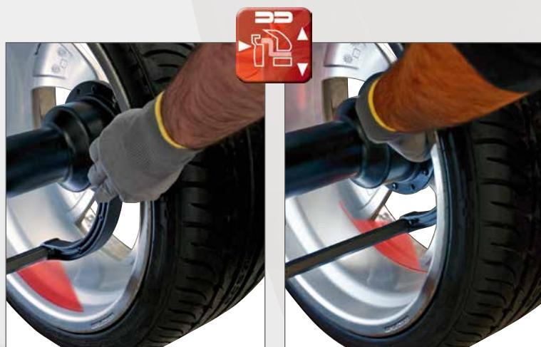
Digitales Messgerät für die Abstands- und Durchmessererfassung bis zu 28 Zoll mit AUTOSELECT, das **die Auswuchtprogramme automatisch aktiviert**. Der Arm kann auch mit dem System LASERBLADE (optional) ausgestattet werden, das den Bediener bei der Wahl der inneren Ebenen der Leichtmetallfelge ohne Gefahr von Fehlern leitet und extrem gut ersichtlich ist. Für die automatische berührungslose Radbreitenmessung ist der Sonardetektor TL3 erhältlich (optional).
