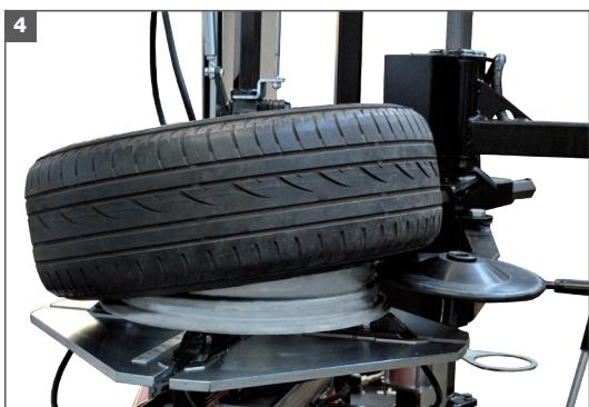
4. Le **GRAND DISQUE** permet de soulever le pneu et de détacher le talon inférieur.
