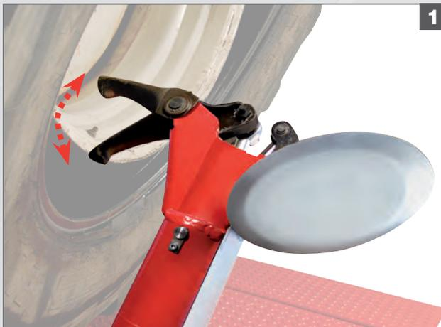
**2. Azione automatica combinata, durante la fase di smontaggio, dell'utensile e del braccio morsa. Il cerchio rimane sempre a 5 mm di distanza dall'utensile.**
