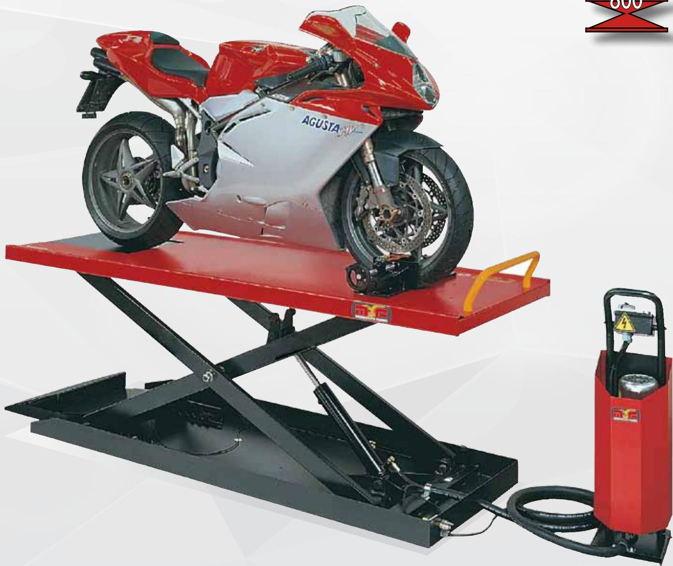
Élévateur hydraulique avec mouvement vertical et cinématisme à ciseaux
