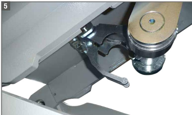
**5.** Dispositivo de “**tipo cocodrilo**” como tope de seguridad para detener el movimiento del elevador en caso de excesiva desalineación entre el lado izquierdo y el derecho (ya no es necesario el ojo eléctrico).
