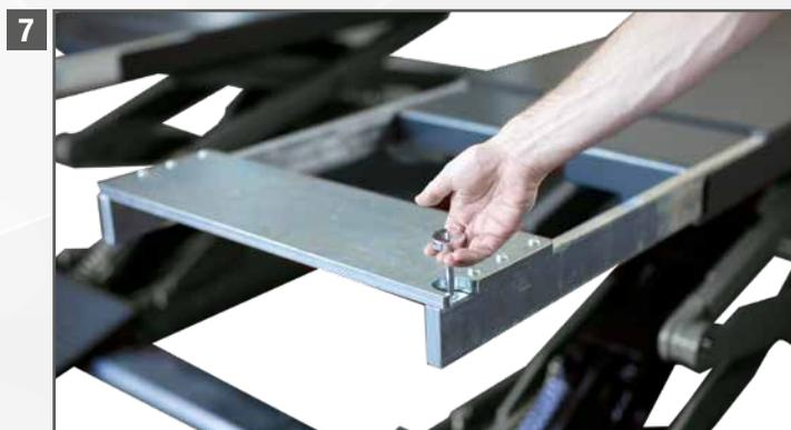
**7.** Plataforma con extensión de cajón para obtener una regulación precisa de la longitud.
