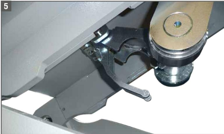
**5.** Dispositif « **crocodile** » servant d'arrêt de sécurité pour stopper le mouvement du pont élévateur en cas de désalignement excessif entre le côté gauche et le côté droit (aucun œil électrique requis).
