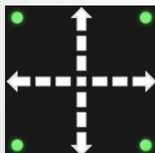
Il pannello sinottico integrato **con indicazioni luminose** permette di verificare lo stato di aggancio dei target e guida l'operatore nelle varie fasi operative. Durante le procedure di compensazione e di sterzata, le frecce luminose forniscono chiare informazioni sulla procedura in corso.
